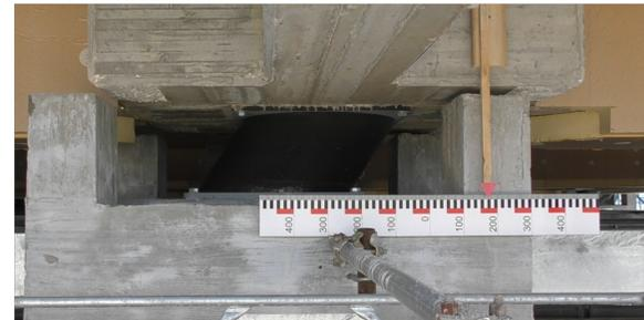
*Isolatore: deformazione nella prova di spinta*
