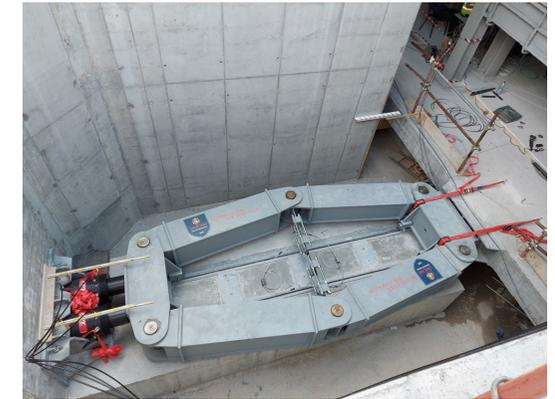
*Dispositivo per prova di spinta di edifici isolati*
